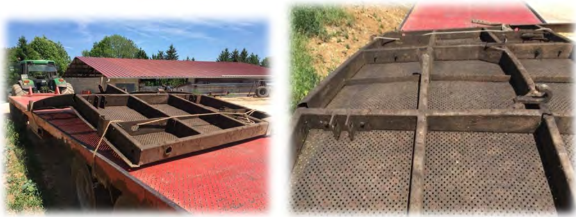
Figure 30 : Photo d'une pré-porte de garage ayant cédé sous le poids du percolât (source : Biogaz ingénierie)
