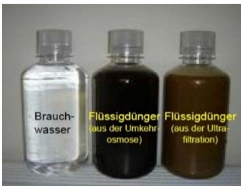
Figure 34: Sous-produits issus d'une étape d'ultra-filtration (rétantat d'UF) + osmose inverse (concentrat d'OI et eau osmosée) (Meritec GmbH, 2004)
